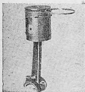
Рис. 6. Проверка кольца по поршню
